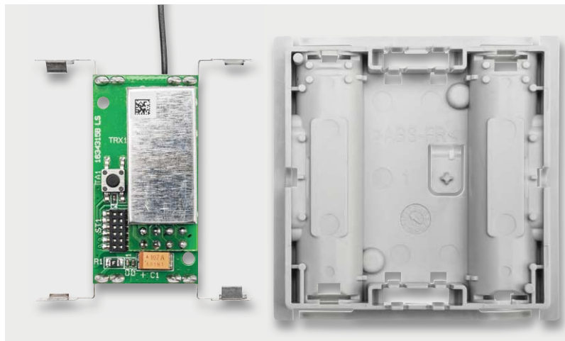
Bild 9: So ist die Rückseite der Schaltwippe zur Montage der Funkplatine hinzulegen.
