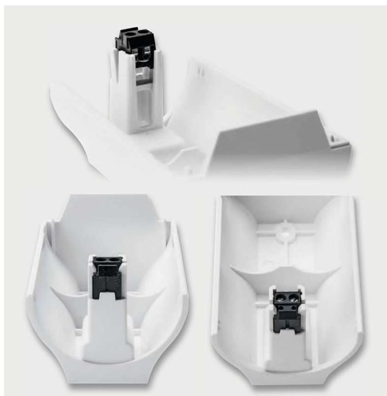
Bild 19: ... und danach die Schraubklemme wie hier gezeigt in den Batteriefachdeckel eingesetzt.
