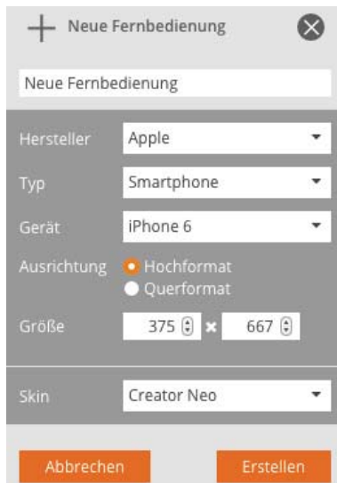
Bild 4: Im Geräte-Einrichtungsdialog kann man bereits viele gängige Gerätelayouts direkt auswählen, aber auch eigene Layouts anlegen.
