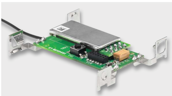
Bild 8: Die komplett bestückte Funkplatine
